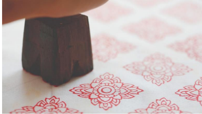
ภาพที่ ๒ กระบวนการพิมพ์ผ้าด้วยแม่พิมพ์แกะไม้ อินเดีย
