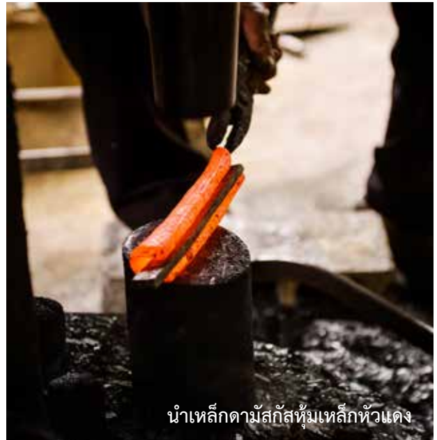
ตีเนื้อเหล็กให้ยืดยาวแล้วตัดพับเข้าหากัน
