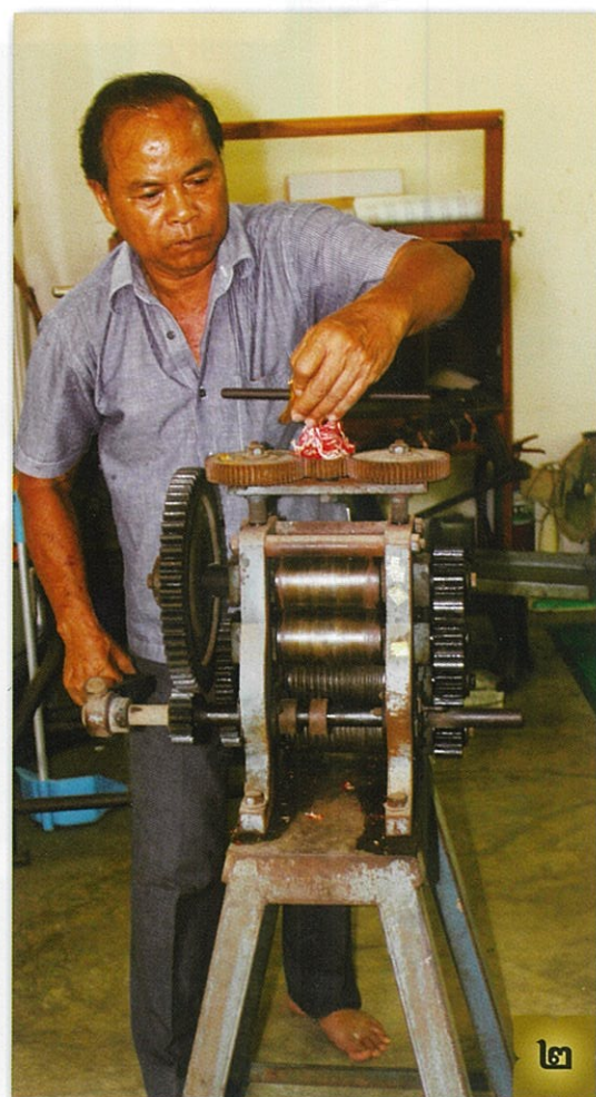
๑. ทองคำที่หลอมแล้วกำลังเทลงในราง ๒. การรีดทองให้เป็นแผ่นด้วยเครื่องรีดทอง
