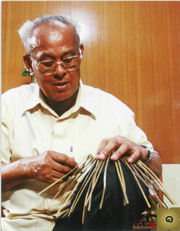
๑-๓. การนำลวดทองเหลืองเส้นกลมมาสานขัดกับลวดทองเหลืองเส้นแบน เพื่อขึ้นรูปกระจาด
