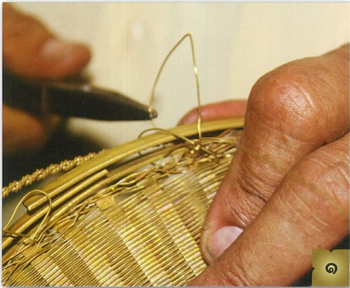
๑-๒. การมัดขอบกระจาดด้วยลวดทองเหลืองเส้นกลมเบอร์ ๒๖ ๓. ขอบกระจาดที่มัดลวดเสร็จแล้ว
