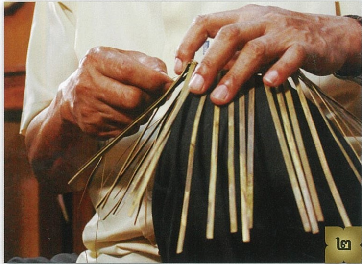
๑-๓. การนำลวดทองเหลืองเส้นกลมมาสานขัดกับลวดทองเหลืองเส้นแบน เพื่อขึ้นรูปกระจาด
