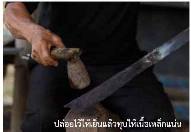
นำเข้าเตาเผาไฟอีกครั้ง แล้วใช้คนเตียวตีด้วยเข็ญ
