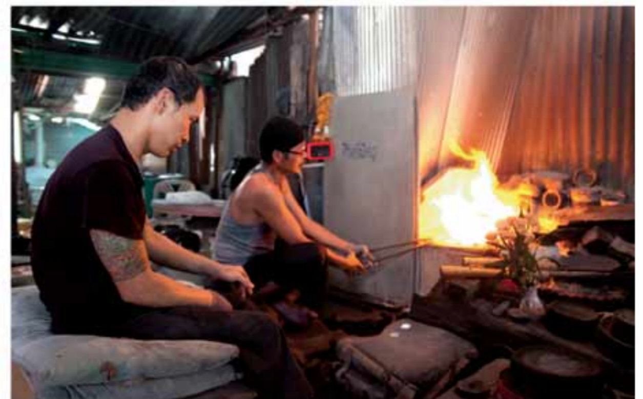
ครูช่างบุญเทิด บัวทองคำ กำลังหลอมสำริดขณะที่ ขวัญเมือง ทองคำพา ช่างแม่ใจจดจ่อรอช่วยตีแผ่นสำริดร้อน Boontherd Buathongkam, bronzesmith master who followed his family trade, heats the metal while his assistant Kwanmuang Thongkampa is ready to strike the hammer.
